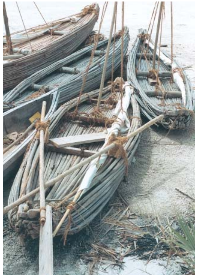
5. D'APRÈS LES EMPREINTES DE NATTES (ci-dessus, flèche) laissées dans le mélange bitumineux qui recouvrait la coque d'un bâtiment datant de -2500 à -2000, on a pu reconstruire les bateaux en roseaux qui naviguaient durant l'Âge du bronze, en Oman. Ils ressemblaient aux bateaux en palmes qui naviguent encore aujourd'hui, à Bahreïn, dans le golfe Persique (ci-contre ; ces bateaux n'ont pas été calfatés).
