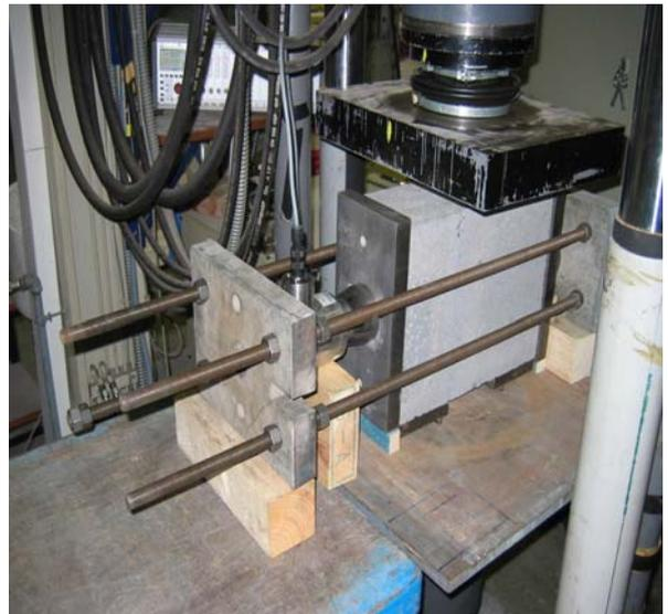
La charge de précompression doit être maintenue dans les limites de  $\pm 2\%$  de la valeur initiale. S'assurer que la rigidité des poutres utilisées pour appliquer la charge de précompression est suffisante pour permettre une répartition uniforme de la charge.
