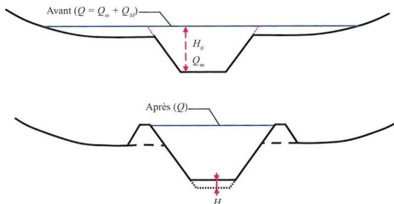
**Figure 4.5.** Élévation du niveau de l'eau et enfoncement du lit mineur dus à la suppression des débordements dans le lit majeur.
