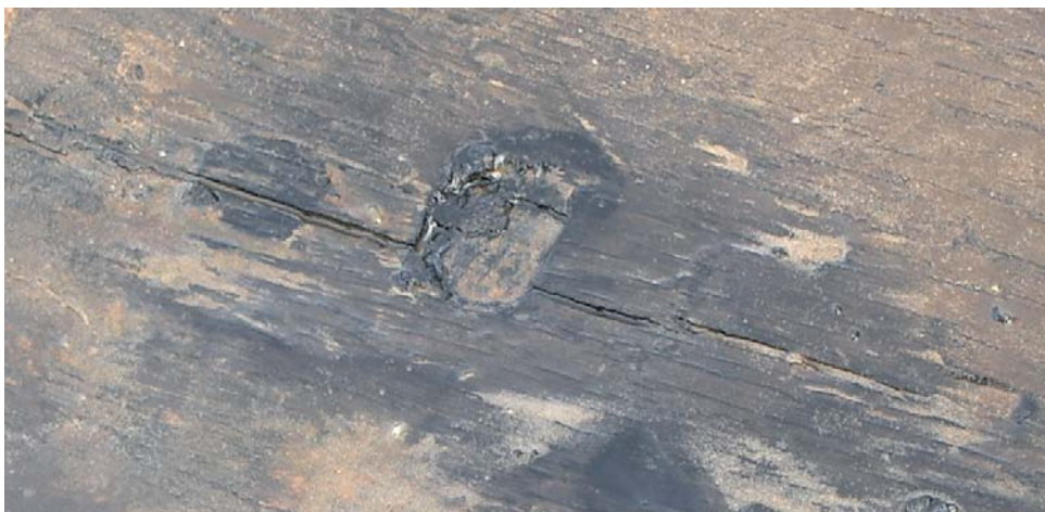
Afb. 12. Rondom het meest zuidelijke (voorlijk?) afgeplugde gaatje in de bodem tekent zich een zwarte vlek af. Ook lijkt er een pekachtige massa aanwezig te zijn.
