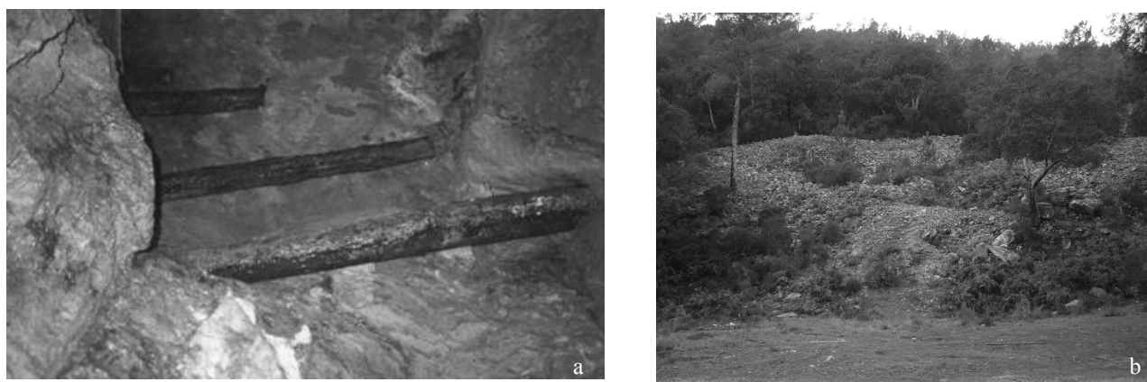
Figura 1: a. Desmonte de filão na mina da Moirama (trabalho mineiro do início do século XX); b. Escombrela de mina na Serra de Santa Justa.
