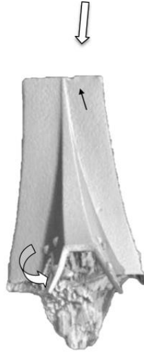
Rotation des bois suite aux chocs. Flèche noire : heurt. Flèches blanches : direction et rotation probables.
