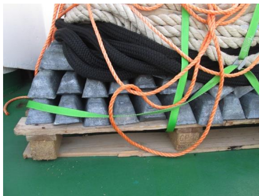
Plombs d'équilibre de charge sur le navire de recherche Alk en 2014. 44 plombs de 30 kg soit 1,320 t. sur le pont !
