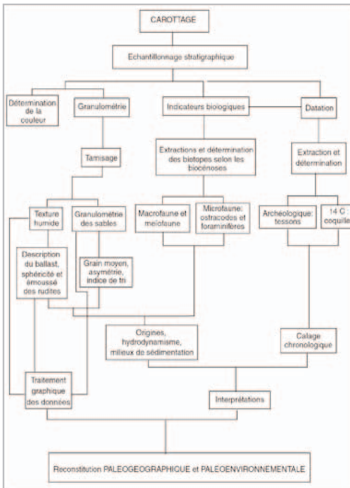
Fig. 6 - Méthodologie utilisée pour l'analyse des échantillons (DAO L. Stefaniuk).
