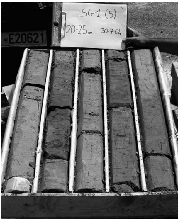
Fig. 6 - Aspetto delle argille marnose attribuite al Pliocene inferiore. Il cartello indica il sondaggio e la profondità.
