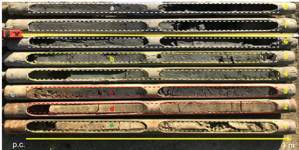
Fig. 5. Foto del carotaggio completo con indicazione delle varie fasi di attività del canale (elaborazione Giovanni Sarti, Dipartimento di Scienze della Terra-UNIFI).
