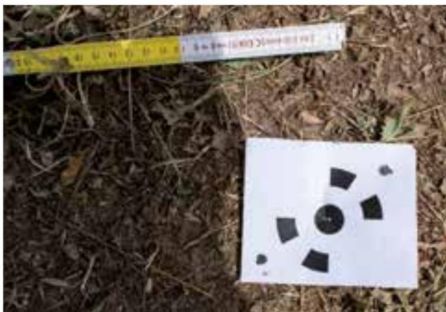
Fig. 2 Un *Ground Control Point* (*GCP*) il cui centro viene misurato con *GPS/RTK* per la realizzazione del rilievo aerofotogrammetrico. Si notano i simboli neri identificativi del punto che vengono riconosciuti automaticamente dal software durante la fase di analisi dati.
