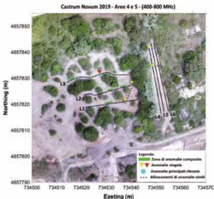
Figura 7. Analisi e posizionamento della anomalie GPR registrati nelle Aree 4 e 5
