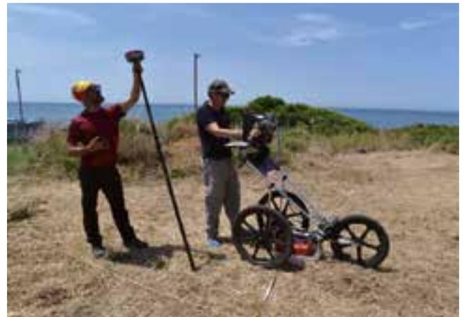
Fig. 1 Rilievo dei punti aerofotogrammetrici di riferimento a terra e delle aree indagate con tecnica *GPR* con *GPS/RTK (Stonex A6000 con antenna integrata)* affiancato dal carrello sui cui era installata la strumentazione *GPR*.
