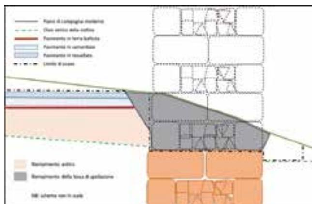
Fig. 4 Sezione N-S delle mura del castrum in corrispondenza dell'ambiente 1. Schema diacronico degli interventi
