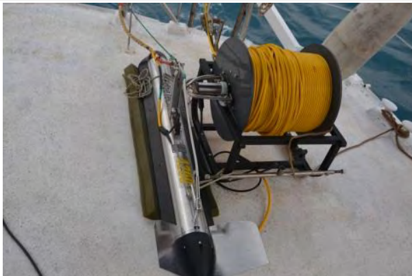
Εικόνα 3.5 : Τομογράφος υποδομής πυθμένα τύπου Ringer 3,5kHz και Ηχοβολιστής πλευρικής σάρωσης (SSS), E.G&G. 272 TD τορπίλη διπλής συχνότητας (100 και 500kHz) στα αριστερά, και δεξιά Τομογράφος υποδομής πυθμένα τύπου chirp υψηλών συχνοτήτων και Ηχοβολιστής πλευρικής σάρωσης Edgetech 4200 τορπίλη διπλής συχνότητας (100 και 400 kHz) .
