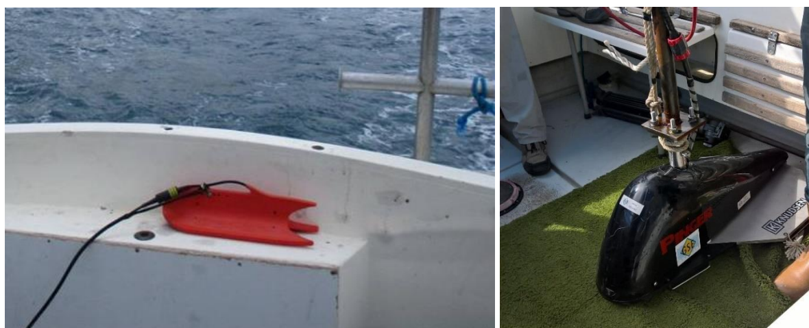
Le sidescan sonar (gauche) et le sub bottom profiler (droite) avant leur mise à l'eau.
