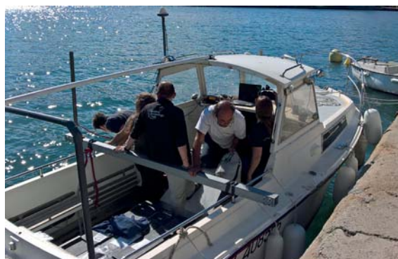
Figure 5. le bateau équipé du sondeur (bâbord) et du sonar (tribord), cliché A. Albaret.
