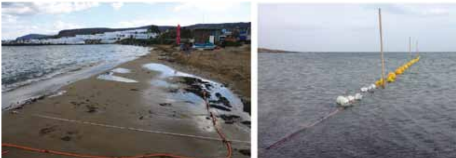
Εικ. 3. Λεπτομέρειες από τη διενέργεια των ηλεκτρικών τομογραφιών μέσα στη θάλασσα στους Αγίους Θεοδώρους
