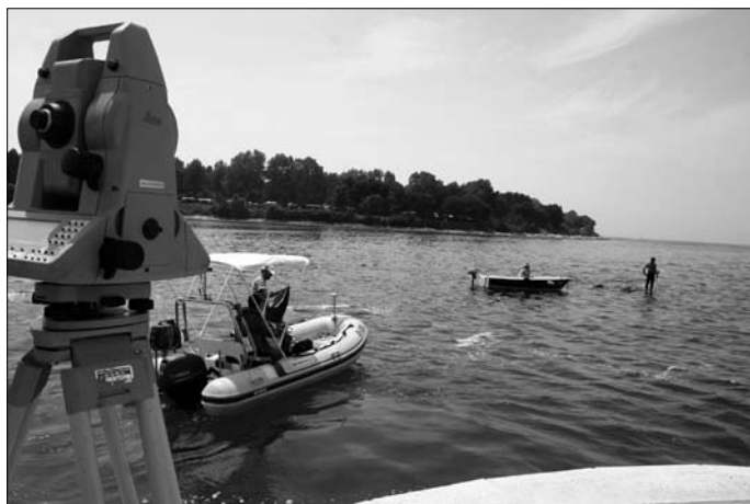
Fig. 4 – La stazione totale ed il gomnone adibito al rilevamento multibeam (per acque poco profonde).
