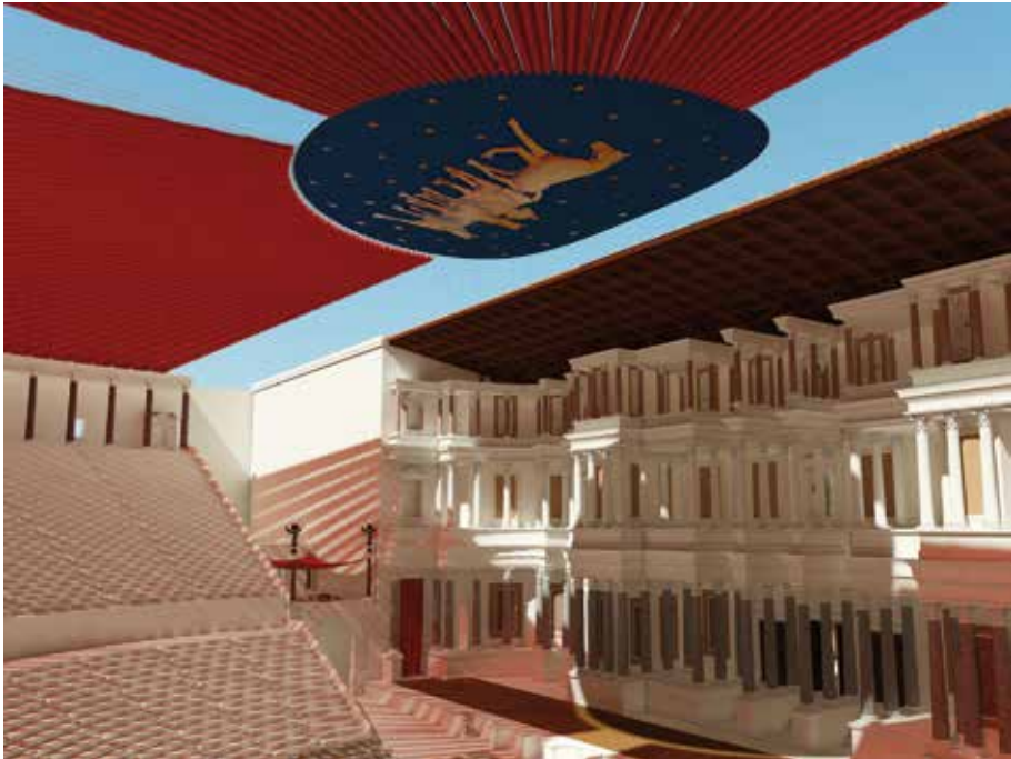
Fig. 6 – Hypothèse de uelum à cordes sur le théâtre de Pompée (UCBN – Plan de Rome, France)
