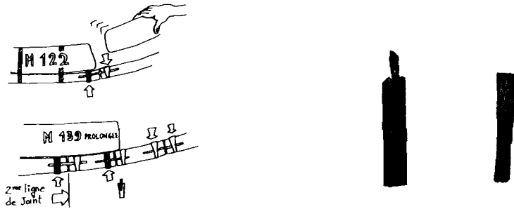
Fig. 2 Chevilles cylindriques et chevilles coniques: a et b: dessins de coupe (détails pris sur l'épave de la Bourse à Marseille); c et d photographies des 2 types de chevilles de bordé.
