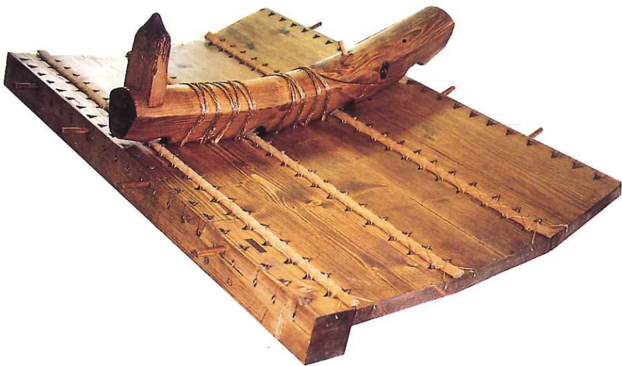
Epave grecque Jules-Verne IX, Marseille Fin du VI e s. av. J.-C. Détail des assemblages par ligatures du bordé et de la membrure de l'épave. Les chevilles horizontales servaient à maintenir en place les planches du bordé avant leur ligaturage. (D'après M. Rival, C.C.J.-C.N.R.S.)
