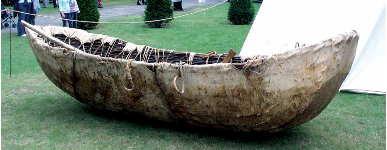
Fig. 9 – Reconstitution d'un curragh historique avec une armature en saule et une couverture par peaux de bœuf, présentée au Bedford River festival, Grande-Bretagne, 2008 (photographie S. Speed, Wikimedia commons).
