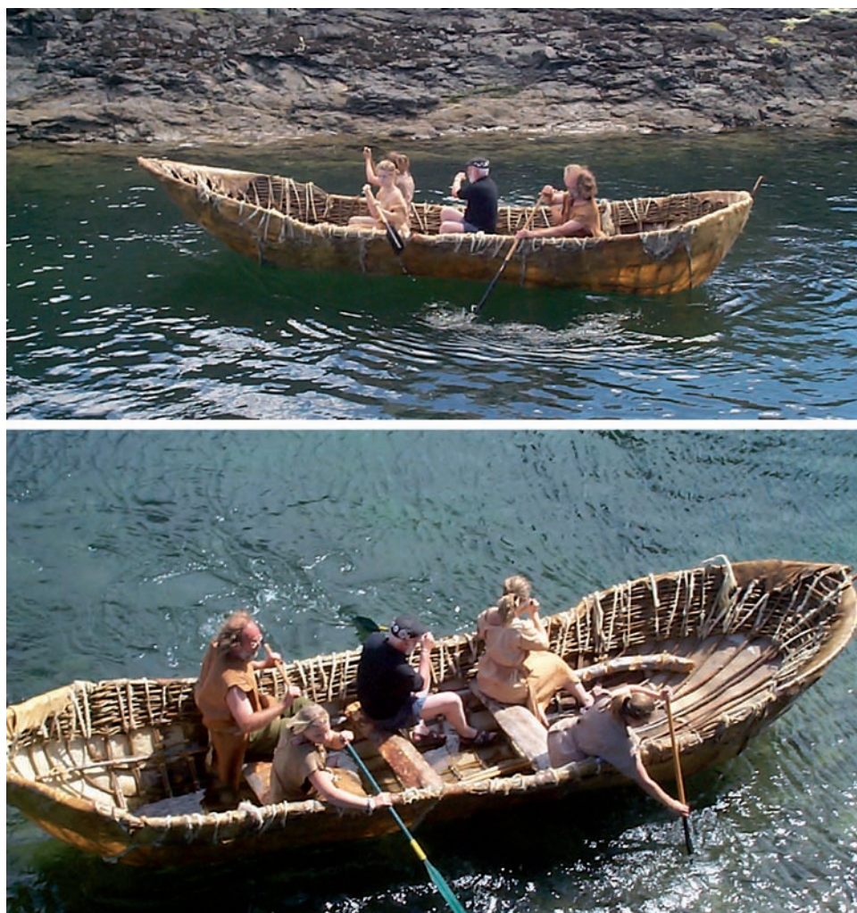
Fig. 21 – Reconstitution d'un grand curragh conforme aux connaissances techniques et matériaux accessibles durant la Préhistoire holocène (cliché : H.R. Stokes-Williams). Armature en saule, couverture par une dizaine de peaux de boeuf. Elle a été réalisée par le parc Archaeolink (Aberdeenshire, Écosse), sous la conduite de Mark Knightly et Peter Faulkner (maître-fabriquand de coracle) : https://helenrachelstokeswilliams.wordpress.com/category/boat .
