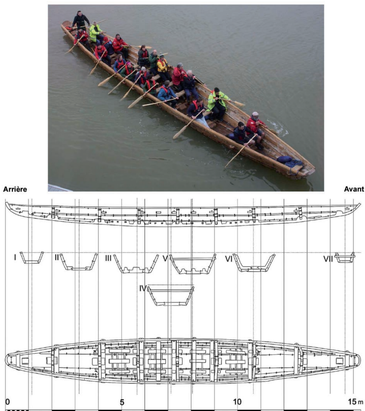
Fig. 23 – « Morgawr », reconstitution de 2012 à pleine échelle d'un bateau de la tradition « à bordages ligaturés », architecture basée sur les épaves de Ferriby, fin III e /début du II e millénaire av. J.-C. Les sections sont numérotées et font face à l'avant (d'après Van de Noort et al., 2014 ; photo : Jane Cartledge ; dessin : Lucy Blue et Paolo Croce).
