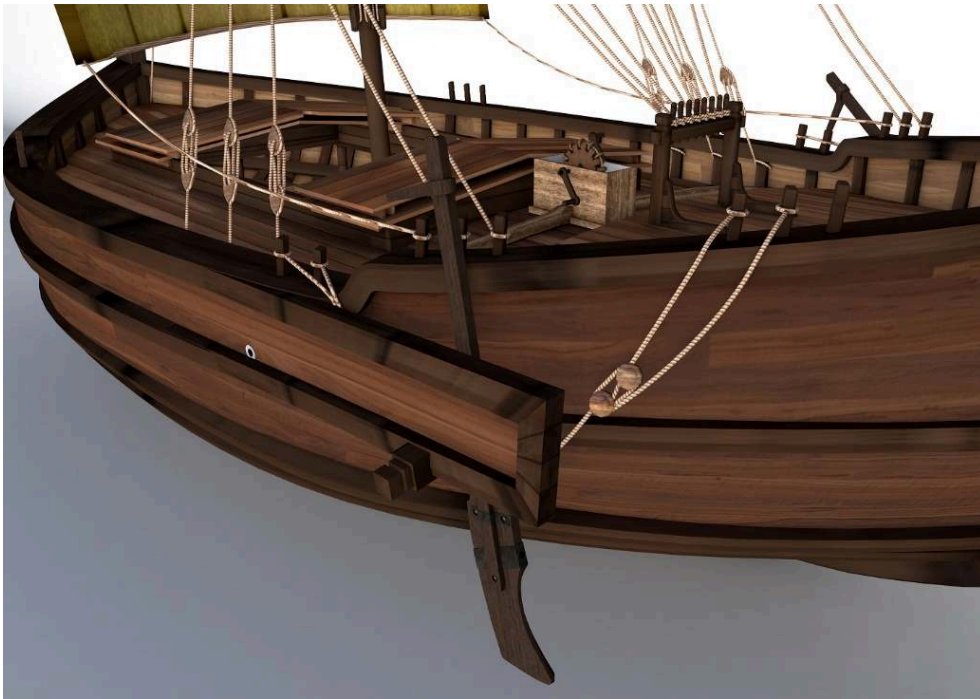
Port-Vendres (Pyrénées-Orientales), Port-Vendres 1 ; au second plan, vue du bac de réception des eaux de la sentine et du système d'entraînement de la pompe de cale
