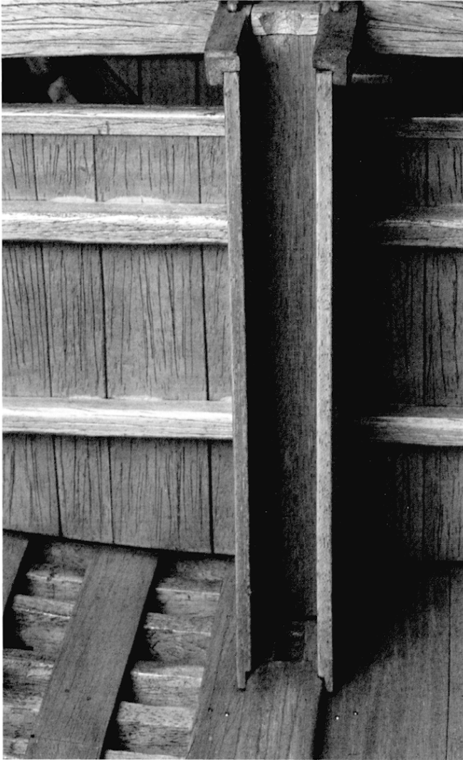
Fig. 5: L'emplanture du mât avec son fourreau d'étambrai. Au fond, cloison de séparation entre la cale à dolia et la proue (photo L. Damelet, CCJ, CNRS, Aix-en-Provence).
