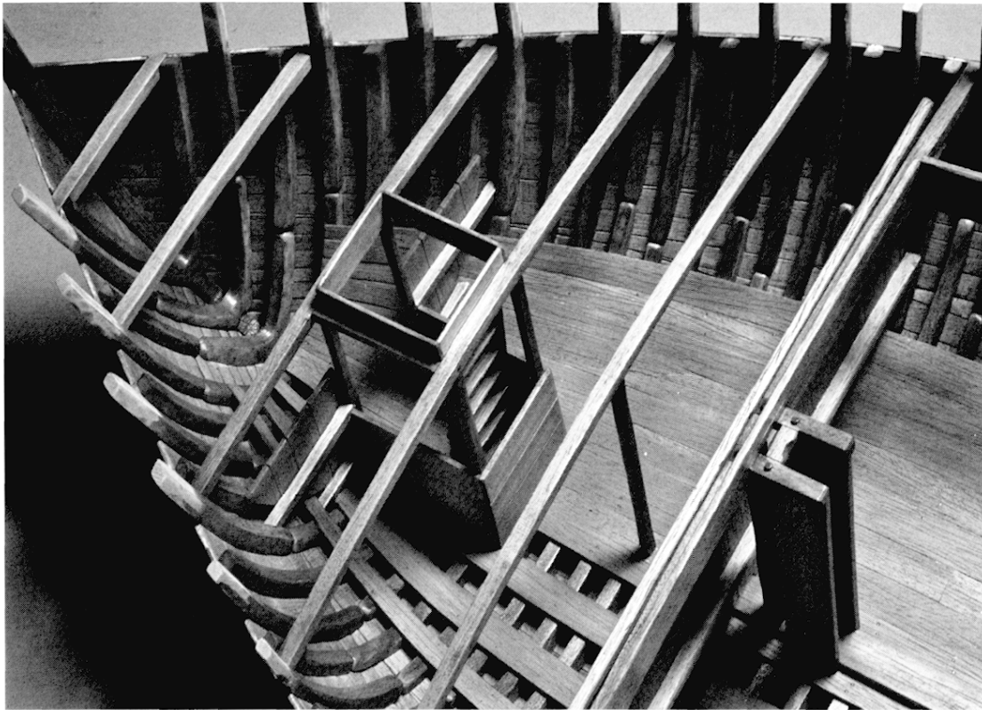
Fig. 10: Détail de la caisse de descente avant (photo L. Damelet, CCJ, CNRS, Aix-en-Provence).
