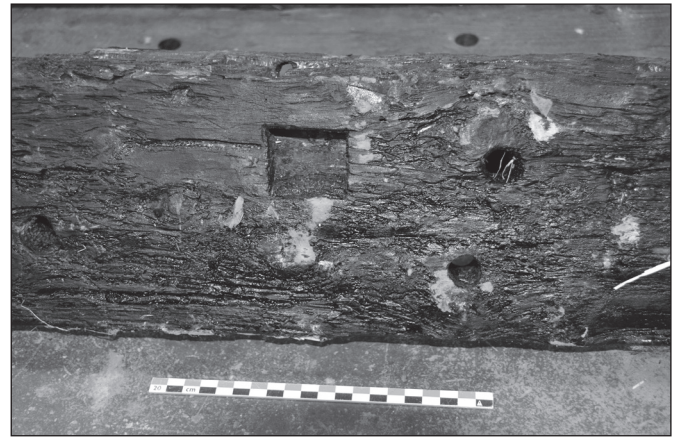
Fig. 1 : Épave Port-Vendres 1. Fenêtre ouverte sur la face externe de la troisième virure bâbord et destinée à l'insertion d'un tenon de réparation. Le passage de la cheville de blocage est visible dans la fenêtre. Cliché : M.-P. Jézégou, RASSM.
