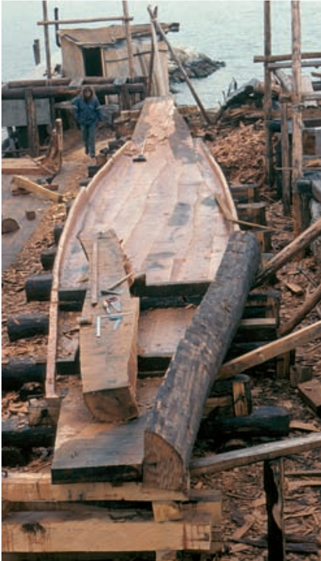
Fig. 11. Installation de deux demi troncs sur le sommet des bordages de transition au niveau de la poupe de Altaripa . Façonnés par réduction, ils assumeront la liaison entre la sole et les flancs au niveau des extrémités. On les appellera les cuillères (photo BÉAT ARNOLD).
