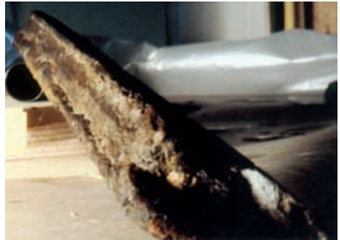
Fig. 6. Chalands de Chalons-sur-Saône : can d'un bordage travaillé au rabot (cliché Musée Denon, Chalons-sur-Saône).
