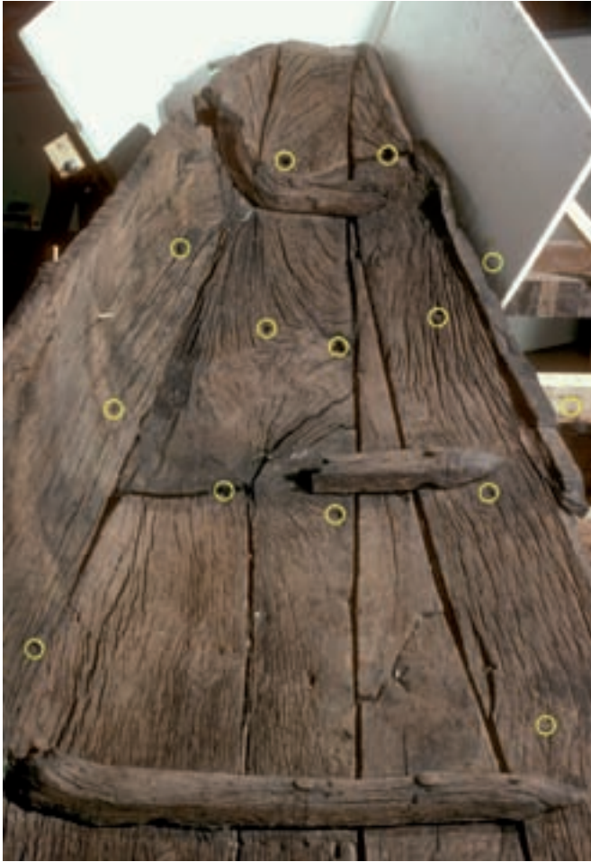
Fig. 6. Chevilles rondes présentes sur l'extrémité étroite, c'est-à-dire la poupe d' Yverdon 2 (d'après Arnold 1992b, fig. p. 26).
