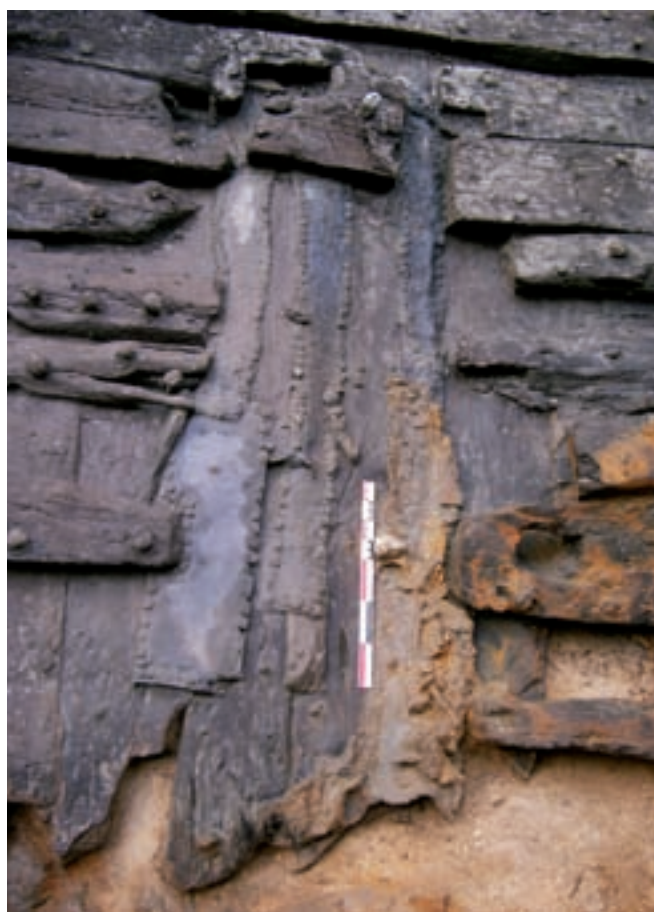
Fig. 8. Palâtrage en plomb (photo M. Guyon/INRAP).
