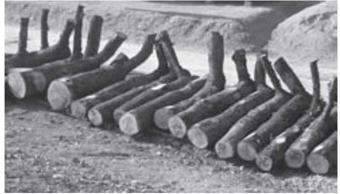
Fig. 9. Stock de courbes correspondant approximativement au tiers de celles que nécessite le façonnage de la membrure d' Altaripa (photo Béat Arnold).
