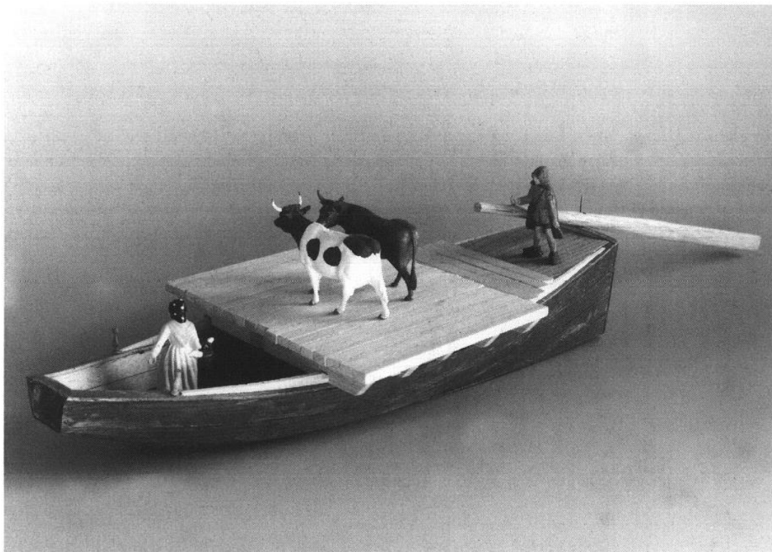
9. Photographie de la maquette du bac à traîle, d'après la photographie. Cette coque est celle d'une cyselante sur laquelle on a installé une plateforme destinée à recevoir les charrettes. Ce type de bateau ne descendait pas l'Isère : il reliait simplement une berge à l'autre pour faire traverser la rivière aux passagers, aux charrettes et aux bétail. La maquette représente un bac de 8,5 m de long et de 2,3 m de large.
