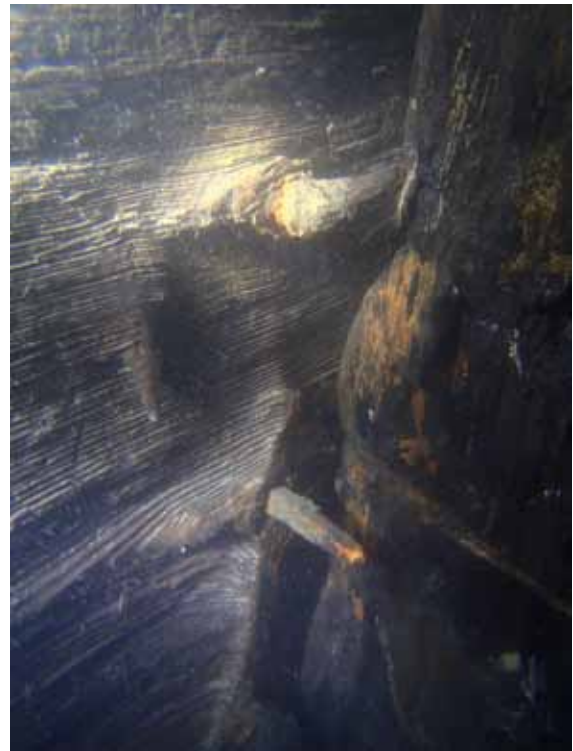
Fig. 16 – Epave Arles-Rhône 14 , vue des clous de fer enfoncés de l'extérieur pour maintenir les allonges de membrures en place (photo K. Boscolo / 2ASM).
