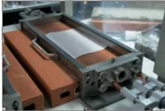
Figure 3.18 : essai de « longueur décollée »
