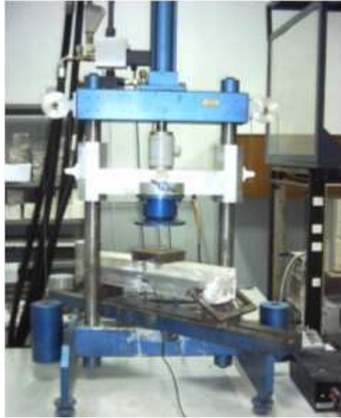
Figure 3.16 : presse 50 KN, essai de flexion 4 points
