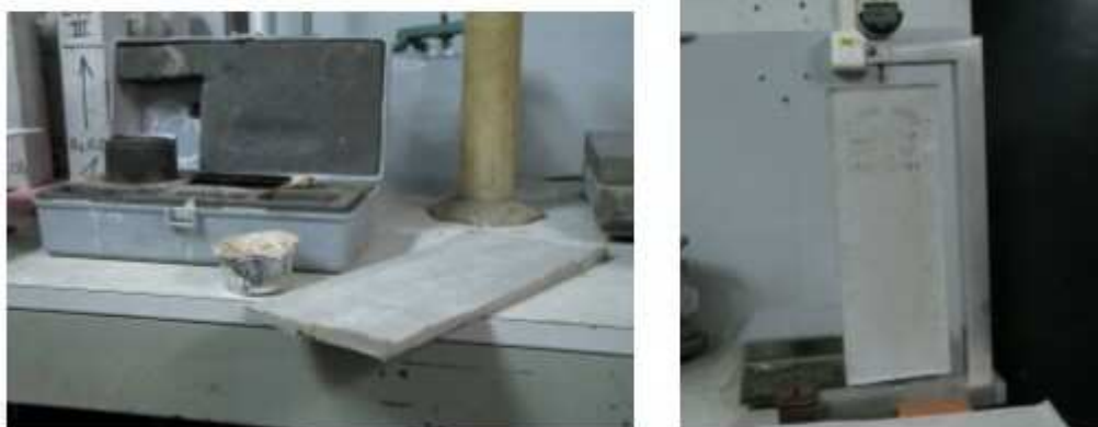
Figure 3.13 : collage de plots sur les éprouvettes 1×15×40 cm (à gauche), mesure avec un rétractomètre du retrait après 24 heures pour les éprouvettes provenant des essais libres ou non adhérents.
