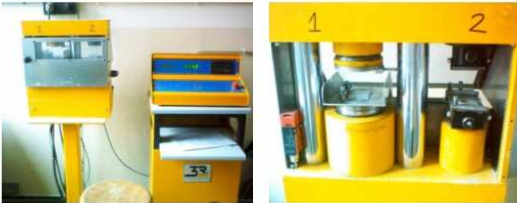
Figure 3.2 : presse pour les essais de flexion et de compression sur éprouvettes 4×4×16 cm
