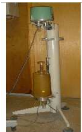
Figure 3.9 : four ATG (système de pesée en partie haute et four en partie basse)
