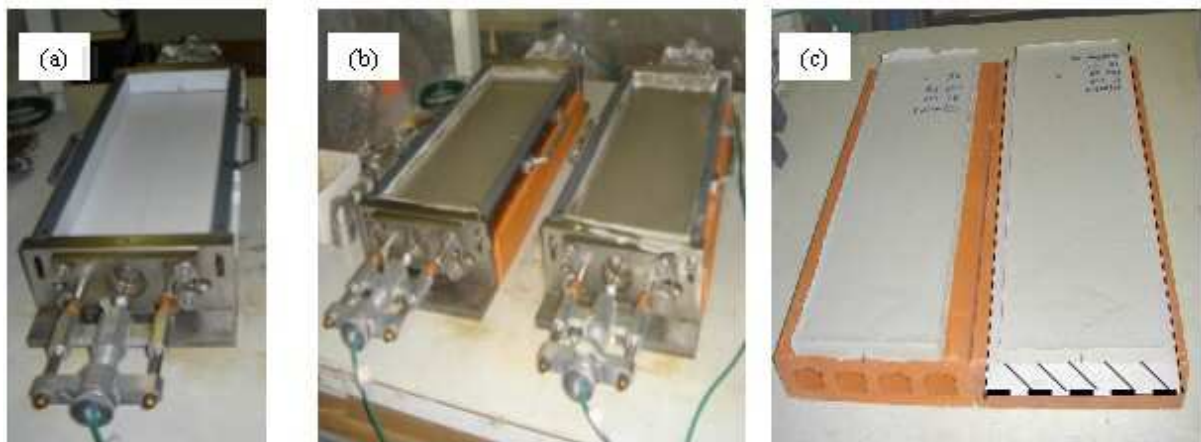
Figure 3.12 : appareil de mesure du retrait au jeune âge en configuration « libre » (a), sur briques (b) et éprouvette après démoulage d'un essai sur brique sans et avec papier Joseph interposé entre la brique et le mortier (c)
