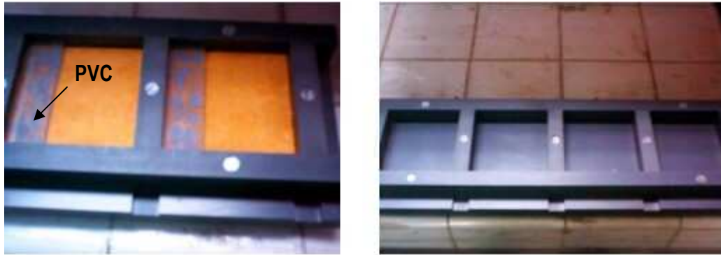
Figure 3.14 : moule pour briquettes 1×10×10 cm , réservations en PVC collées sur les briquettes (à gauche)
