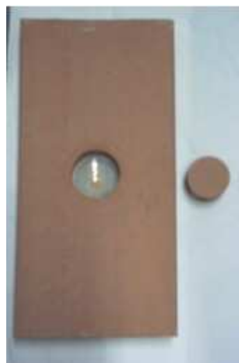
Jauge collée sur la face inférieure du mortier grâce au carottage de la brique
