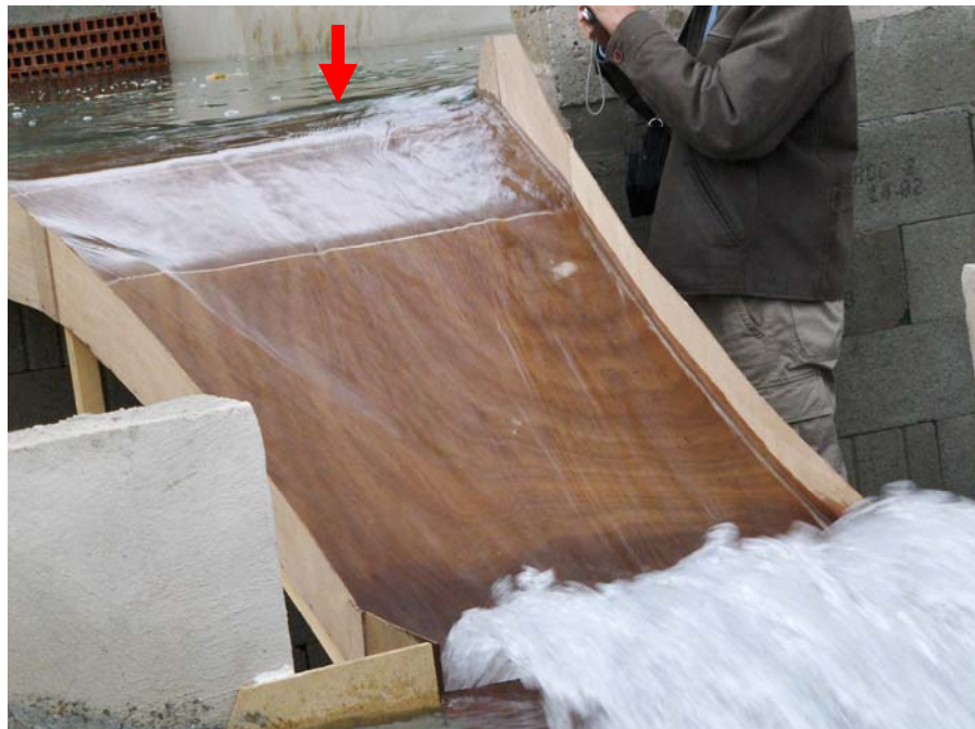
Photo – Ecoulement fluvial, section critique (flèche) et écoulement torrentiel sur ce modèle réduit d'un évacuateur de crue de barrage réalisé par SCP. A l'aval, dissipateur d'énergie en saut de ski.
