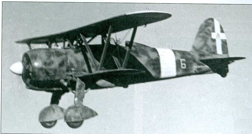
Un biplano CR.42 del 3° Gruppo in Africa Settentrionale. In evidenza le bombe alari 50T "Torpedine" (g. c. fam. Fissore via G. Garello).
