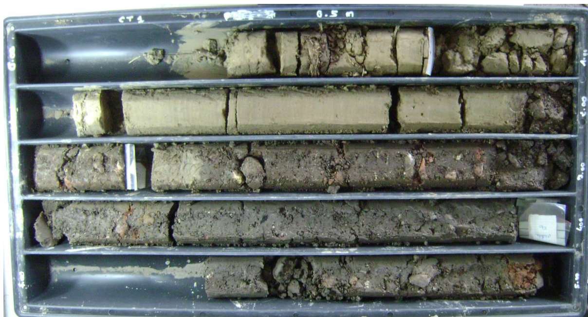
Annexe 6 : Photographie de la carotte CT1 entre 0 et 5 m de profondeur
