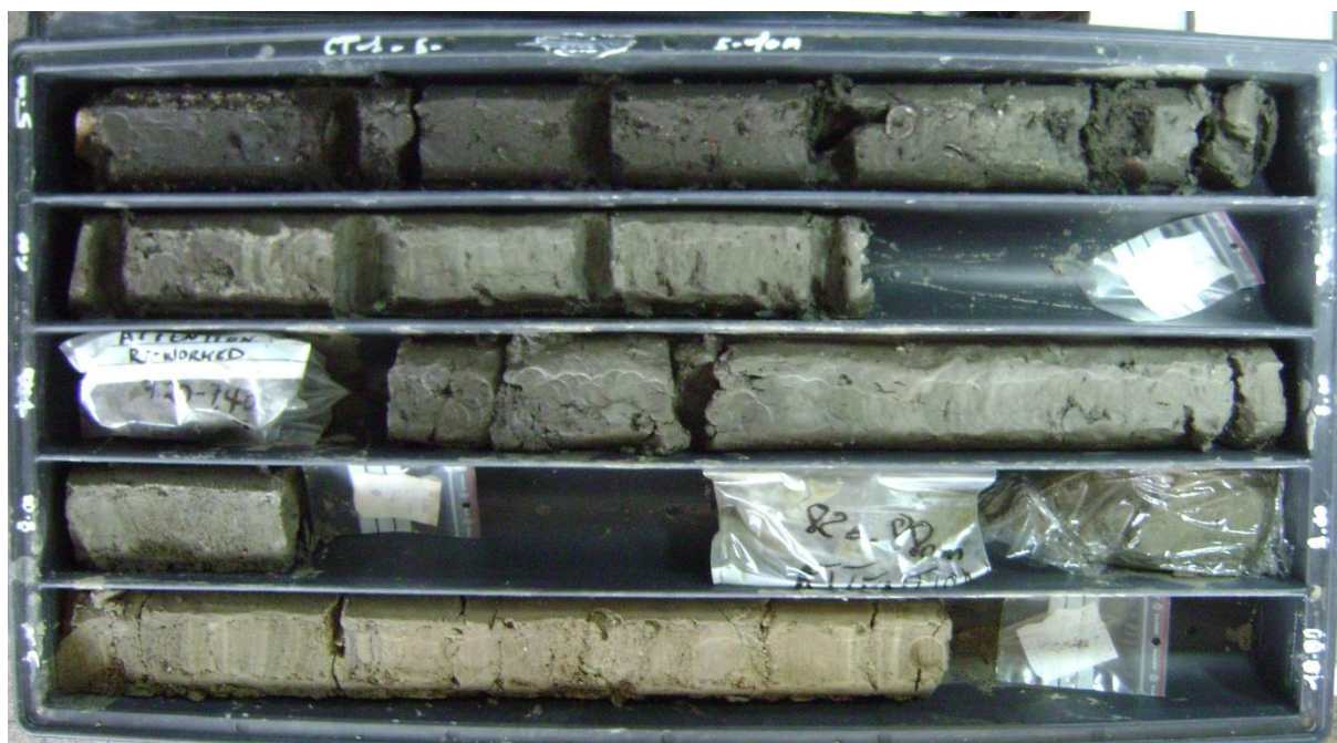
Annexe 7 : Photographie de la carotte CT1 entre 5 et 10 m de profondeur
