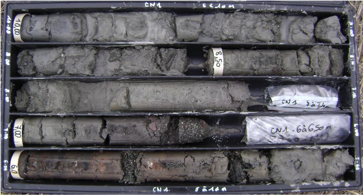
Annexe 4 : Photographie de la carotte CN1 entre 5 et 10 m de profondeur
