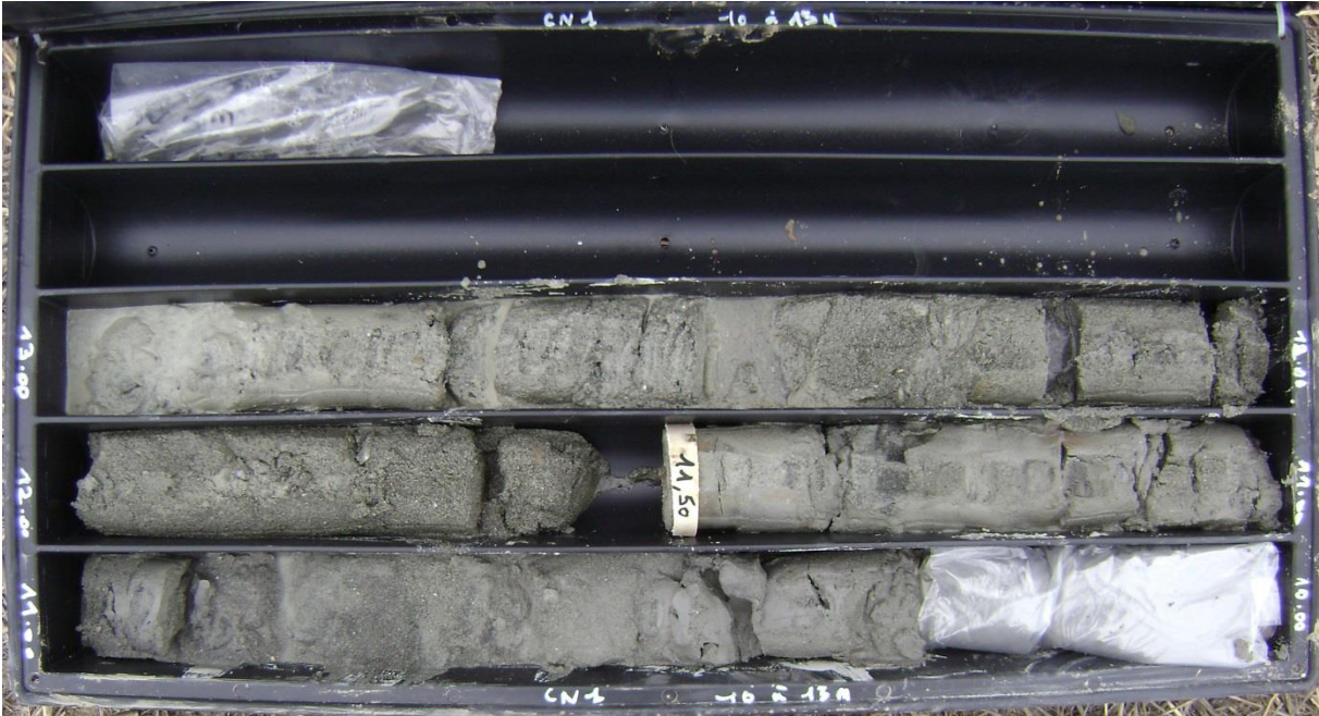
Annexe 5 : Photographie de la carotte CN1 entre 10 et 13 m de profondeur
