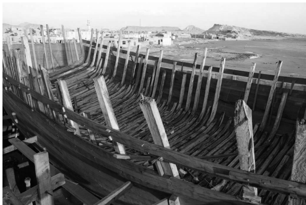
Fig. 17.1 et 2. Un navire coque première en construction en Inde (cl. P. Counillon).
