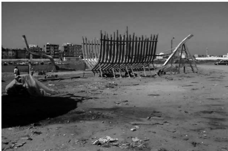
Fig. 18. Un navire “squelette premier” en construction en Égypte (cl. P. Arnaud).
