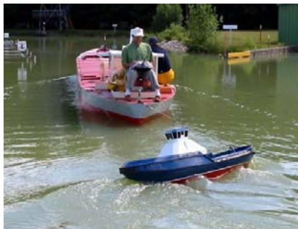
Remorqueur VOITH SCHNEIDER en traction indirecte
